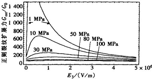
图3 在  $\alpha = \beta = 0^\circ$  和  $c = 10 \text{ u/m}$  时, 外加电场  $E_3$  与力场  $\sigma_{33}$  对正则化裂纹扩展力  $G_{ext}/G_0$  的影响
