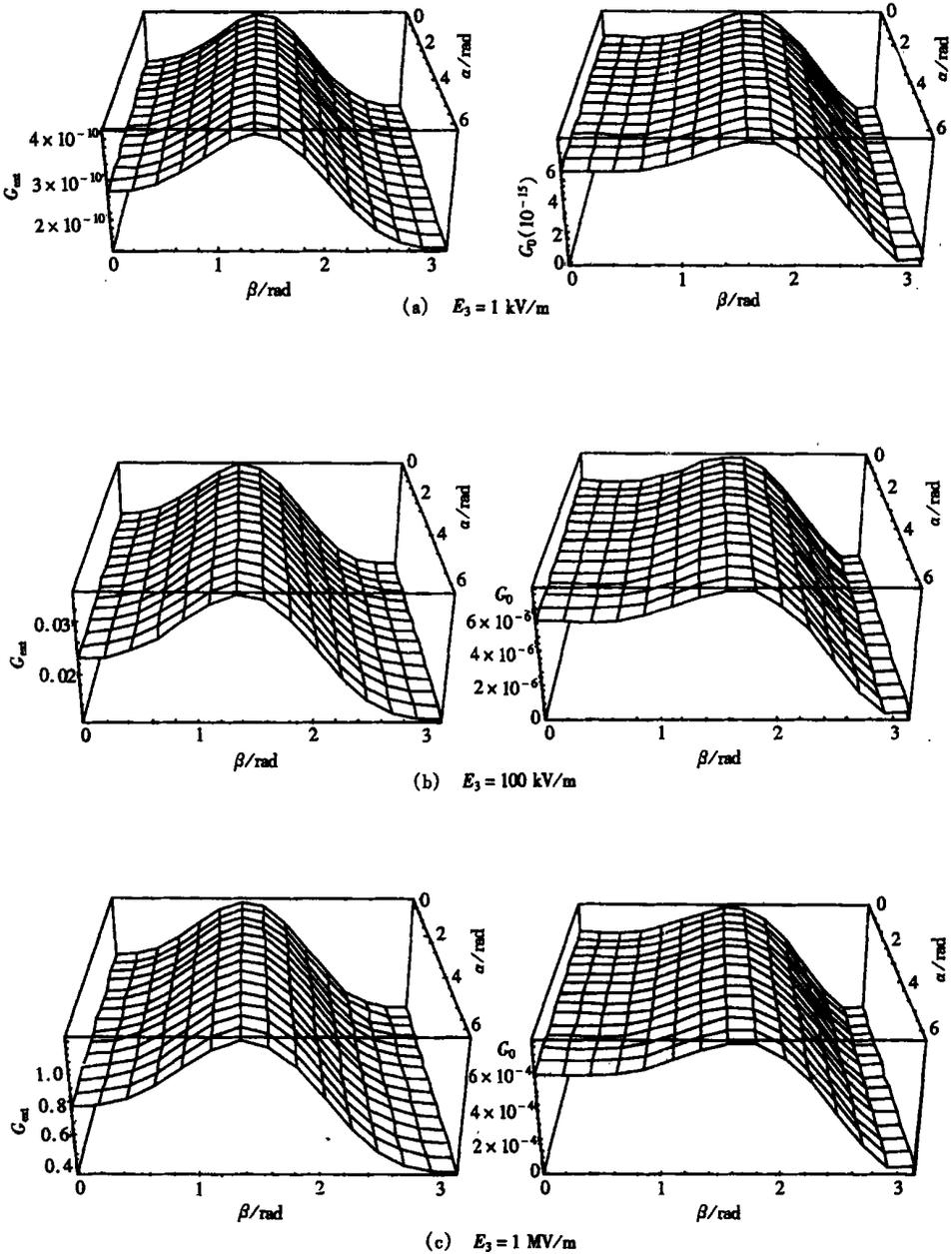
图5 在给定电场作用和  $c = 10 \text{ }\mu\text{m}$  时, 裂纹分布角度对裂纹扩展力  $G_{\text{ext}}$  和  $G_0$  (N/m) 的影响
