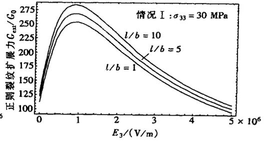
图4 在给定机械载荷作用下, 晶粒形状比  $L/b$  对正则化裂纹扩展力  $G_{ext}/G_0$  的影响
