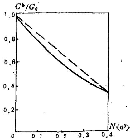
图16 含微裂纹介质的剪切模量
