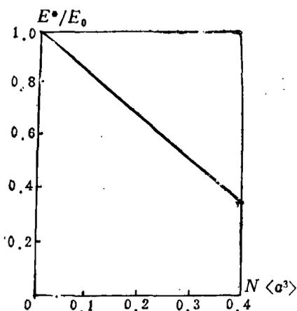
图15 含微裂纹介质的有效弹性模量
