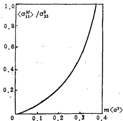
图14 含微裂纹的基体中平均应力
