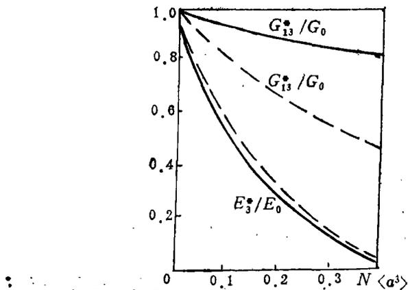
图17 含单向排列微裂纹介质的模量
